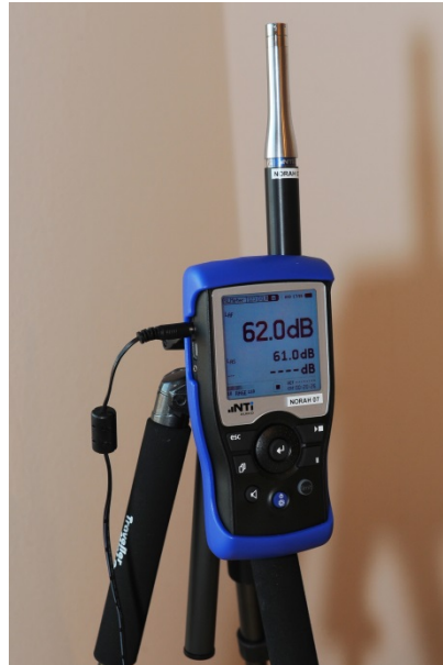
Abbildung 2-24: In der NORAH-Schlafstudie eingesetzter Klasse1-Schallpegelmesser XL2 der Firma NTi Audio. Der Schallpegelmesser wurde jeweils nah am Ohr des Schlafenden platziert, die Messung des Schalldruckpegels und der Geräuschaufzeichnung fand während der gesamten Nacht statt.
